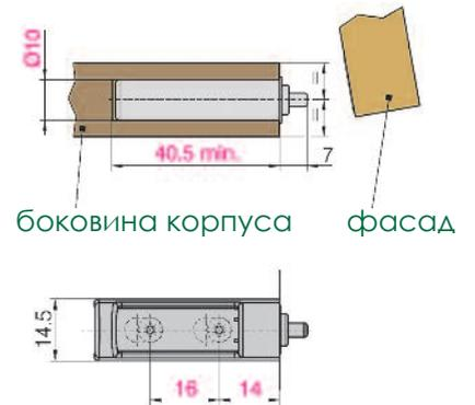
Система, состоящая из магнитной защелки-толкателя и специальных петель с обратной пружиной, обеспечивающая автоматическое открытие и закрытие дверки простым нажатием. Усилие открывания 1 кг.
